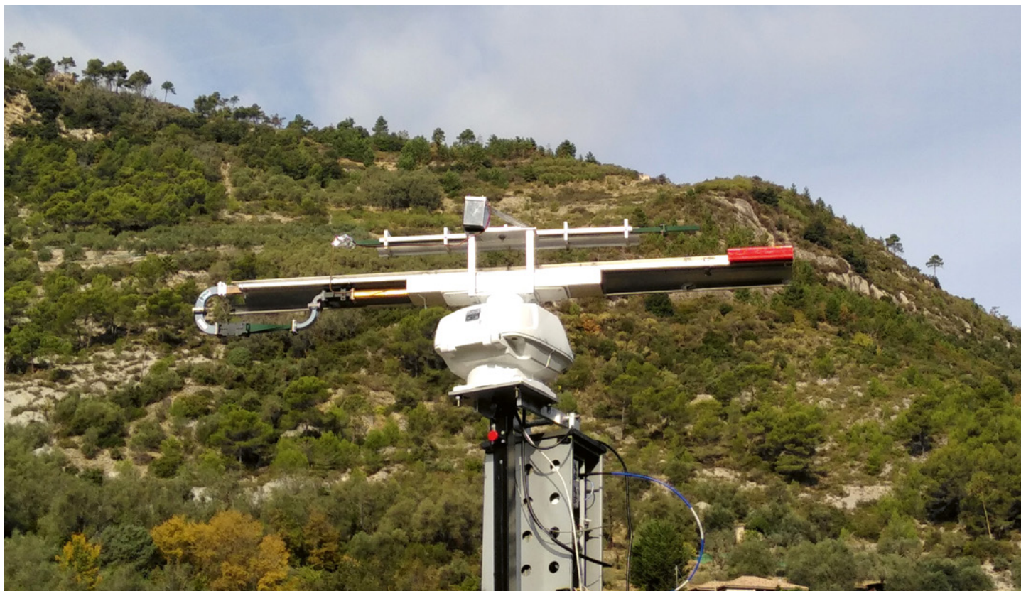
Obrázok 8: Harmonický radar vyvinutý v rámci projektu STOPVESPA [©LIFE STOPVESPA].
